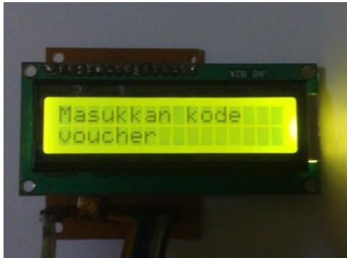
**Gambar 4. 3** Sebelum input kode voucher Kwh meter
