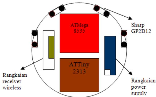
**Gambar 6.** Skema mekanik bagian atas
