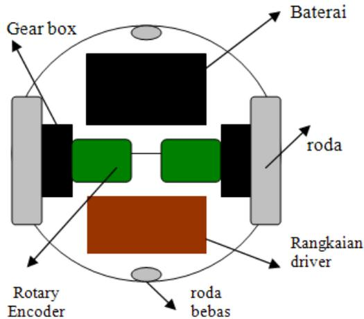
**Gambar 5.** Skema mekanik bagian bawah
