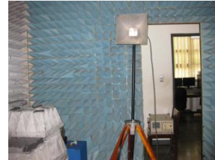
Gambar 2.9 Pemasangan antenna Rx dan spectrum analyzer
