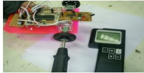
Gambar 21. Pengujian Kecepatan motor.
