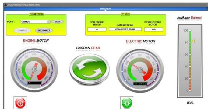
Gambar 12. Tampilan saat mesin 2 menyala dan energi baterai terpakai.
