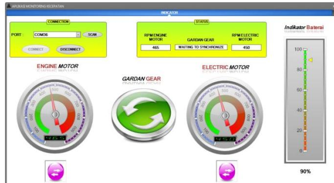
Gambar 11. Tampilan saat indikator daya baterai mendekati penuh dan proses sinkronisasi
