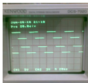
Gambar 5.2 Gelombang PWM phase R-S frekuensi 20 Hz
