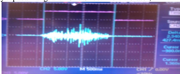
Gambar 4.2 Sinyal Fleksi dan Ekstensi pada Elbow Joint dan hasil output dari rangkaian One Shoot Multivibrator
