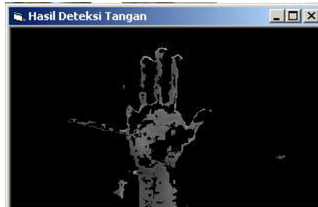
Gambar 15 Hasil segmentasi pada ruangan B dengan batas nilai C_r dan C_b yang pendek
