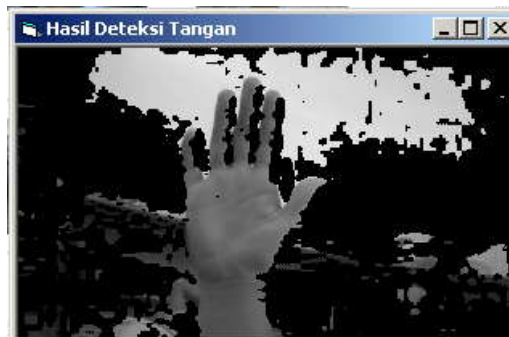
Gambar 16 Hasil segmentasi pada ruangan B dengan batas nilai C_r dan C_b yang lebih panjang
