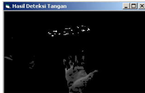
Gambar 13 Hasil segmentasi pada ruangan A dengan batas nilai Cr dan Cb yang lebih panjang
