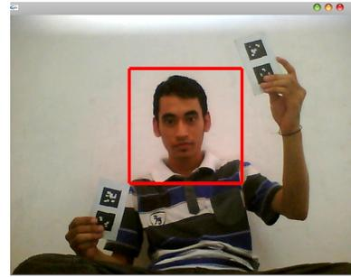
Untuk menganalisa jalan program diperoleh dari terdeteksinya marker dalam menjalankan program. Program dijalankan dengan mencari pola marker yang terekam dalam kamera dengan perbandingan acuan dengan file pola marker yang tersimpan dan telah diintegrasikan dalam program. Dengan jarak tertentu marker tidak dapat terdeteksi, sebab program telah membaca pola tersebut berbeda dari file pola yang tersimpan dalam program. Untuk selanjutnya bisa dilihat dalam tabel dibawah ini.
