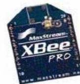
**Gambar 2** Bentuk fisik X-Bee PRO OEM RF Module
