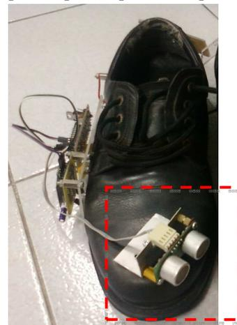
Gambar 2.3 Penempatan Sensor Ultrasonik
