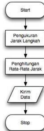
Gambar 2.11 Diagram Alir Perangkat Lunak Deteksi Langkah
