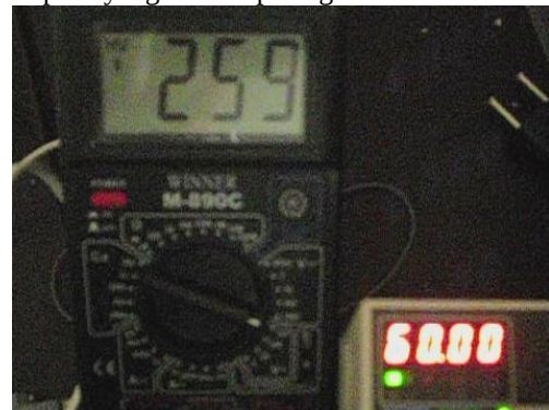
Gambar 4.2 Tegangan Output Inverter untuk Frek.60Hz
