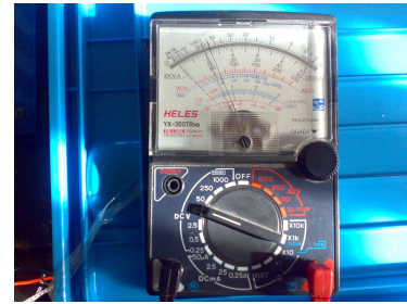
Gambar 4.3 Tegangan Output dari sensor AF-30 saat udara normal Sebesar 2.8 Volt
