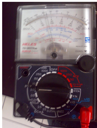
Gambar 4.6 Tegangan Output dari sensor TGS 2442 saat udara normal Sebesar 0.8 Volt
