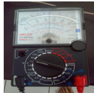
Gambar 4.4 Tegangan Output dari sensor AF-30 saat penuh asap rokok Sebesar 4.8 Volt
