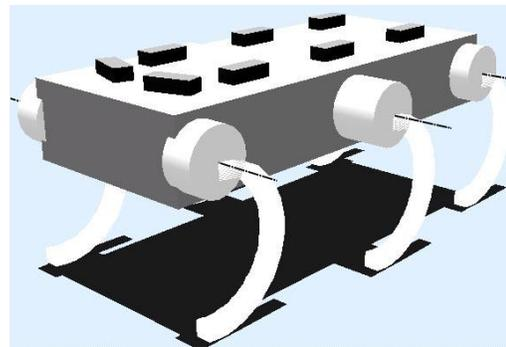
Gambar 6. Model Robot untuk Simulasi
