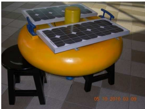
Gambar 12. Casing Dengan Atap Solar Cell
