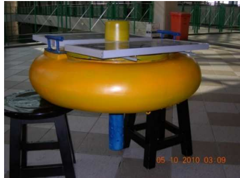
Gambar 13. Casing Lengkap Dengan Sensor di Bawah
