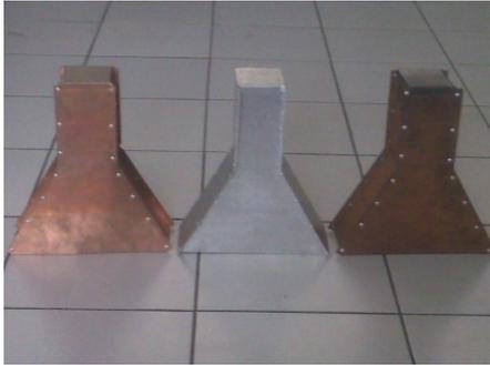
**Gambar 4.** Antena Horn Sektoral Bidang-E dengan bahan seng, aluminium dan tembaga
